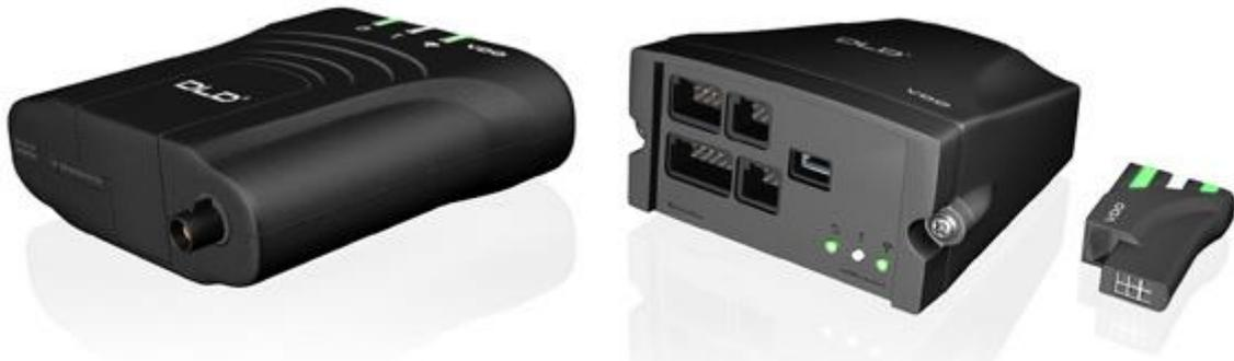
Il connubio tra il tachigrafo digitale VDO e il dispositivo telematico DLD® offre una soluzione comoda e sicura per lo scarico dei dati legali sia della memoria di massa del tachigrafo digitale VDO (DTCO® 1381, vers. 1.3a o superiore) che della Carta Conducente e la trasmissione in modalità criptata degli stessi in sede, tramite wireless LAN o rete mobile GPRS.
